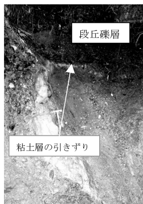
図 8-2 粘土層の引きずり 埴生累層が逆断層で変位し、上位の段丘礫層との不整合面で切れて、埴生累層の灰白色粘土層 30 cm の引きずりが見られる。
