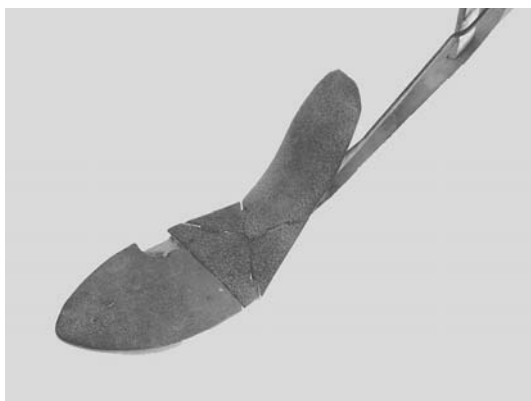
写真13 スキヘラ部分の大きなちょうつがい
